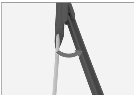
3. Снять щетку с рычага стеклоочистителя.
