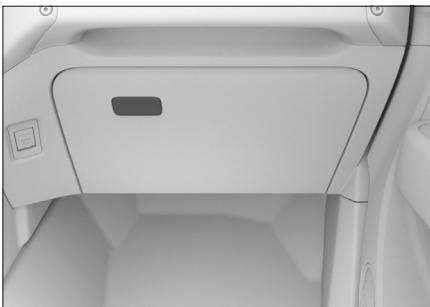
Нажмите кнопку перчаточного ящика. Ящик открывается автоматически.
