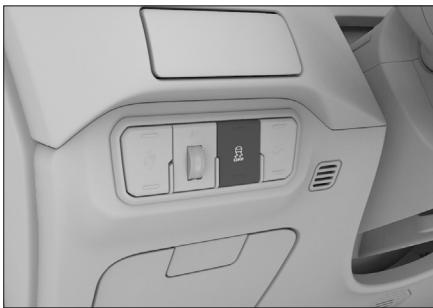
После включения двигателя нажмите кнопку выключения электронной системы стабилизации движения . Загорится индикатор отключения электронной системы стабилизации движения на приборной панели, указывая на то, что система отключена. Нажмите еще раз, чтобы снова включить систему ESC.
