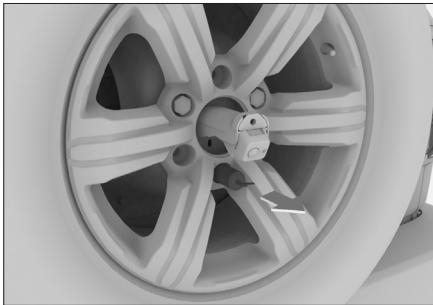
5. Установите съемную втулку на ключ для колесных гаек.
