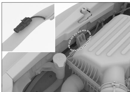
Расположен рядом с корпусом воздушного фильтра, обеспечивает питание постоянного тока 12 В с номинальной мощностью не более 300 Вт. Используется для подключения сервисного осветительного оборудования, кемпинга и т. п. Для использования убедитесь в том, что внешнее подключение в порядке, запустите двигатель и нажмите кнопку внешнего питания.
