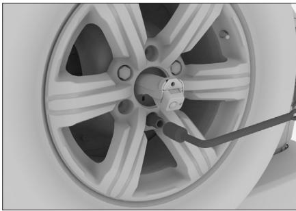
7. Если на автомобиле установлены декоративные накладки гаек, сначала снимите их с помощью специального инструмента, поставляемого в комплекте с автомобилем.
