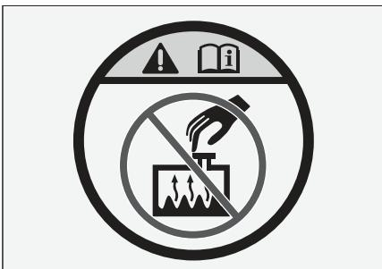
Данный знак расположен на крышке радиатора. Он напоминает, что запрещается открывать крышку радиатора, когда двигатель перегрет. В противном случае существует риск ожогов и выплескания охлаждающей жидкости.
