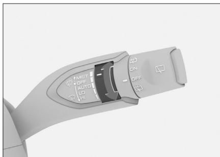
Поворотом кнопки регулировки можно изменить чувствительность датчика дождя и освещенности к силе дождя. Таким образом изменится частота работы передних стеклоочистителей в автоматическом режиме.
