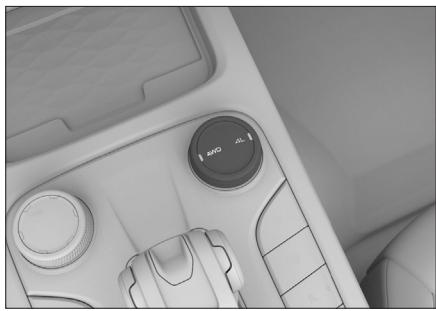
После запуска двигателя убедитесь, что автомобиль неподвижен, переведите селектор переключения передач в положение N, поверните переключатель режима полного
