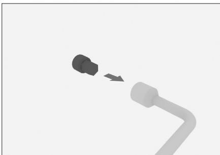
6. С помощью собранного ключа поворотом против часовой стрелки ослабьте гайки на цилиндре замка запасного колеса и снимите их.
