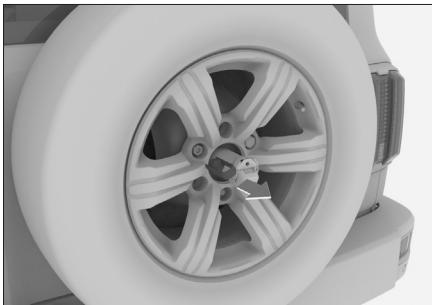
8. С помощью ключа для колесных гаек снимите запасное колесо, ослабив и сняв гайки крепления поворотом против часовой стрелки.
