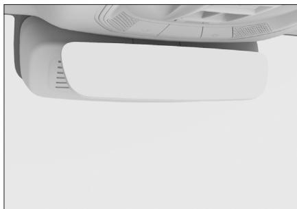
Внутреннее зеркало заднего вида затемняет свет фар движущихся сзади автомобилей в зависимости от яркости света
