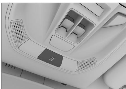
Кнопка выключателя внешнего питания расположена на панели лампы для чтения.
