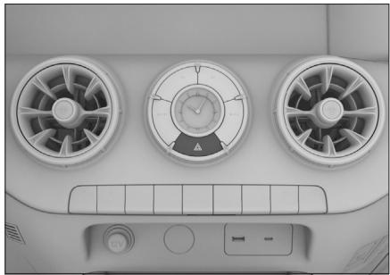
В случае поломки автомобиля или дорожно-транспортного происшествия необходимо включить аварийную световую сигнализацию, чтобы предупредить других участников дорожного движения.
