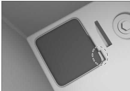
4. Поверните ручку тросика разблокировки положения Р селектора КПП против часовой стрелки примерно на 60 градусов так, чтобы ручка вошла в направляющий паз
