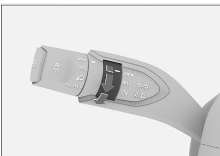
› Когда включены (габаритные огни, подсветка номерного знака), переведите переключатель противотуманных фар  $\text{Fog}$  в положение переднего противотуманного фонаря.
