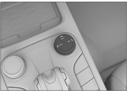
Поверните переключатель режима полного привода, чтобы переключиться между режимами 2H, 4H и 4L. Когда режим выбран, мигает соответствующий индикатор. После завершения переключения индикатор светится постоянно.
