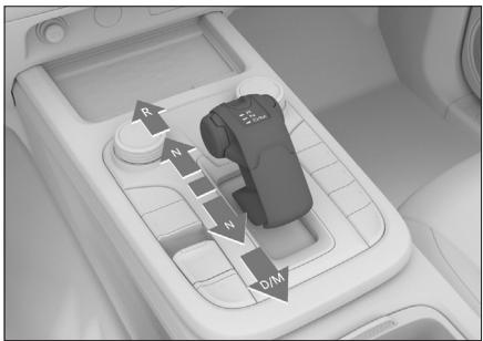
Быстро переведите рычаг селектора передач в необходимое положение; при отпускании рычага он автоматически возвращается в центральное положение.
