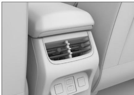
Сдвиньте регулятор в центральной части дефлектора, чтобы отрегулировать направление воздушного потока.
