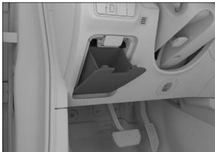
Предохранитель можно увидеть, сняв отделение для мелких предметов (крышку блока предохранителей), как показано на рисунке.
