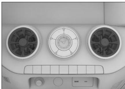
Поверните регулятор в центральной части дефлектора, чтобы открыть или закрыть дефлектор.
