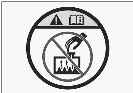
Данный знак расположен на крышке радиатора. Он напоминает, что запрещается открывать крышку радиатора, когда двигатель перегрет. В противном случае существует риск ожогов и выплескивания охлаждающей жидкости.
