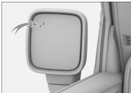
Лампы сигнализации расположены на поверхности левого и правого внешних зеркал заднего вида.
